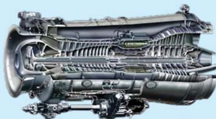
Энергетический ГТД 6, 8 МВт
