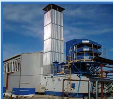
Газоперекачивающий агрегат мощностью 4 МВт
