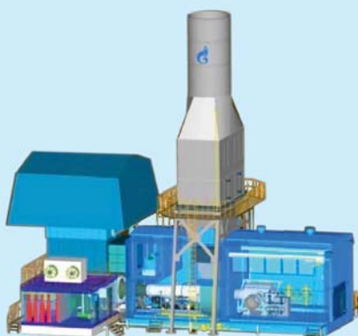
Газотурбинный агрегат мощностью 16 МВт
