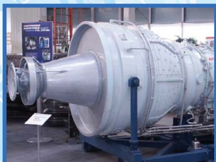
Двигатель АЛ-31СТ для газоперекачивающих агрегатов 16 МВт
