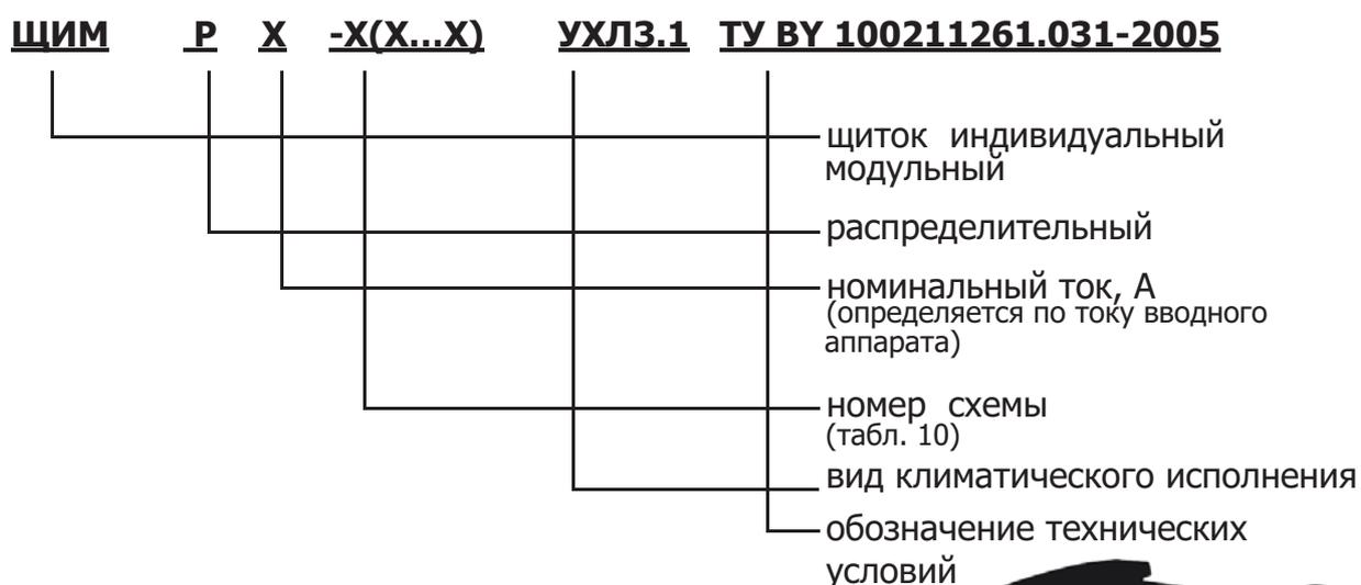
Щитки рассчитаны на установку трех рядов аппаратов: вводного аппарата, который устанавливается в верхнем ряду слева и аппаратов отходящих линий, и предусматривают установку однофазных или трехфазных аппаратов защиты и управления, монтируемых на DIN-рейке, занимающих не более 9 модульных мест в каждом ряду.
