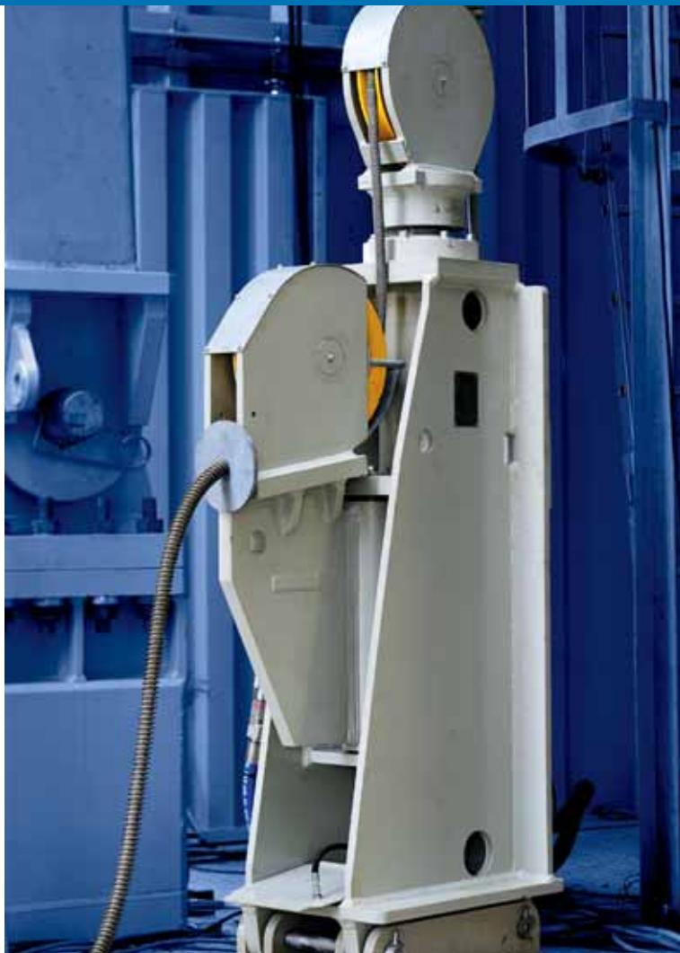
Это эффективное оборудование обеспечивает плавное регулирование усилия в процессе свинчивания-развинчивания (докрепления-раскрепления) бурового инструмента. Благодаря гидравлическому принципу действия раскрепителя производства Bentec обеспечивается максимальная безопасность при работе с ним. Система может приводиться в действие от автономного гидравлического блока (HPU) или входить в состав центральной гидроустановки (CHPU).
