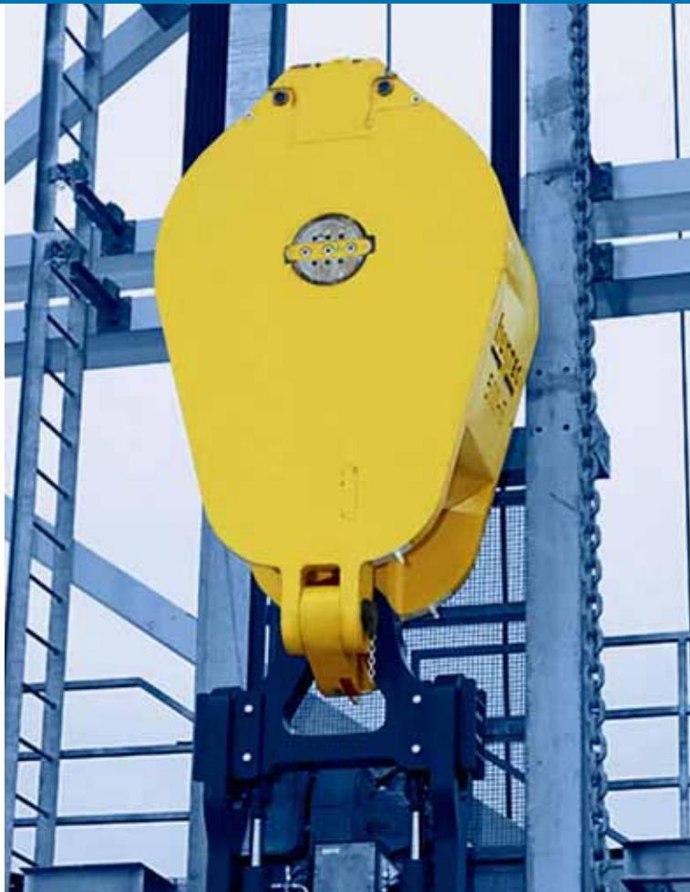
Компания Bentec разрабатывает и производит большой ассортимент талевых блоков, которые соответствуют всем нефтепромысловым требованиям. Достаточный собственный вес блоков обеспечивает их быстрый спуск без нагрузки на крюке. Компактный, «обтекаемый» дизайн исключает возможность столкновения талевого блока с элементами мачты. Благодаря качественному производству и тщательному отбору материалов и комплектующих обеспечивается долгий срок службы.
