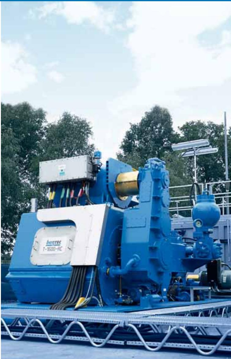
Компания Bentec разработала совершенно новую концепцию буровых насосов. Редукторный привод от электродвигателя установлен непосредственно на самом насосе, электродвигатель является результатом собственной разработки, корпус имеет высокотехнологичное исполнение. Отсутствует внутренний редуктор со всеми его недостатками, в т.ч. нет больше необходимости регулировать натяжение ремня. Конструкция буровых насосов Bentec создана исключительно с учетом их функциональности.
