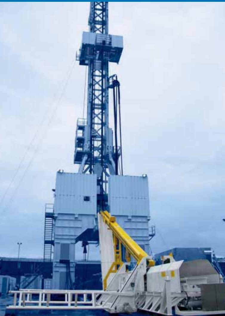
МЕХАНИЗИРОВАННЫЙ ПРИЁМНЫЙ МОСТ BENTEC упрощает и ускоряет спуск и подъем труб со стеллажей на буровую площадку. Подъем труб осуществляется с помощью элеватора и, таким образом, исключается процедура наращивания через шурф.
