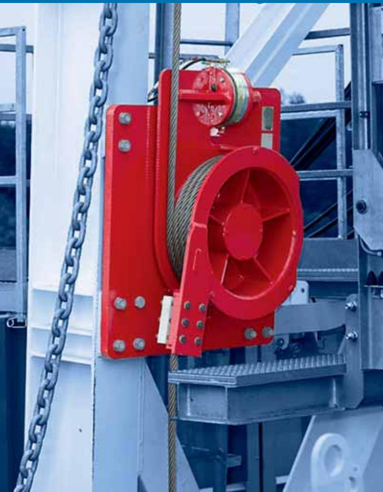
Разработанные для использования с датчиками веса, механизмы крепления неподвижных ветвей талевых канатов Bentec выполнены из высококачественной конструкционной стали и могут эксплуатироваться в температурном диапазоне от -40°C до +55°C
